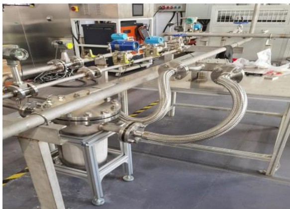
图6 模拟靶冲刷实验照片
