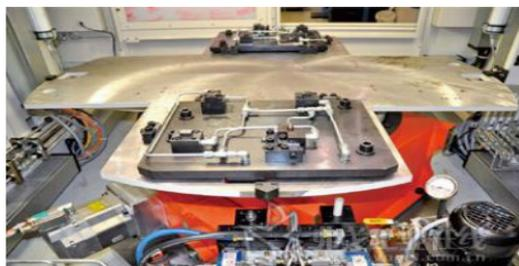
图1 柔性自动化技术在缸孔珩磨机床中的应用
