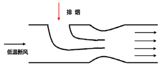
图4 自吸式混新风装置原理
