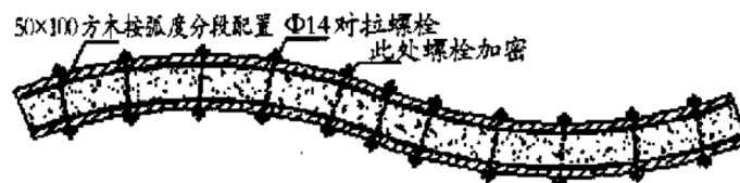
图 9 不规则曲线结构模板封边构造示意图
