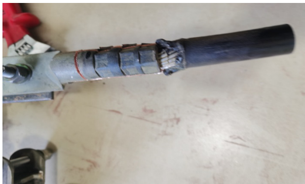
图 1 线夹发热故障
