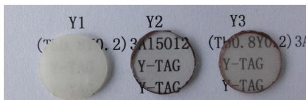
图3 1680°C烧结1 h (Y1)、24 h (Y2)和用两步法(Y3)获得的
