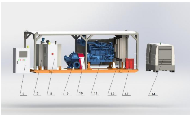
图 2 水力提升动力机组单撬示意图
