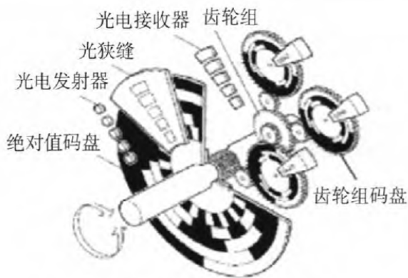
图 3 多圈绝对值编码器应用原理
