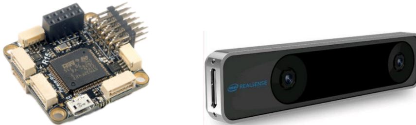
图 1 Pixracer R15 飞控单元 (左)；Intel T265 视觉传感器 (右)
