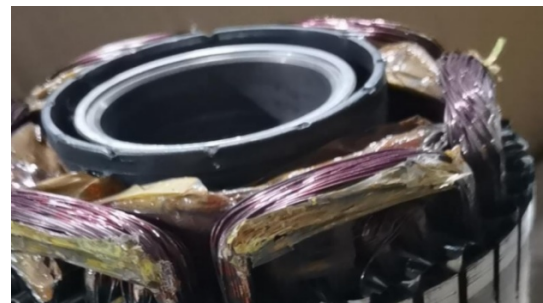
图 5 绕组及绝缘隔纸有明显磨损痕迹并发黄
