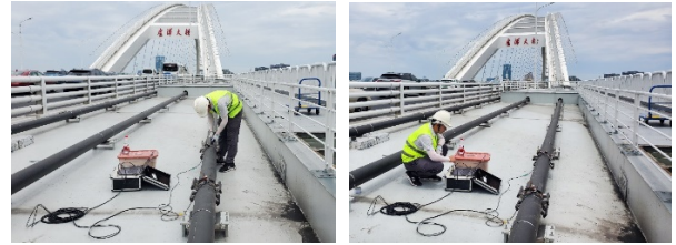
图4 水平拉索现场测试
